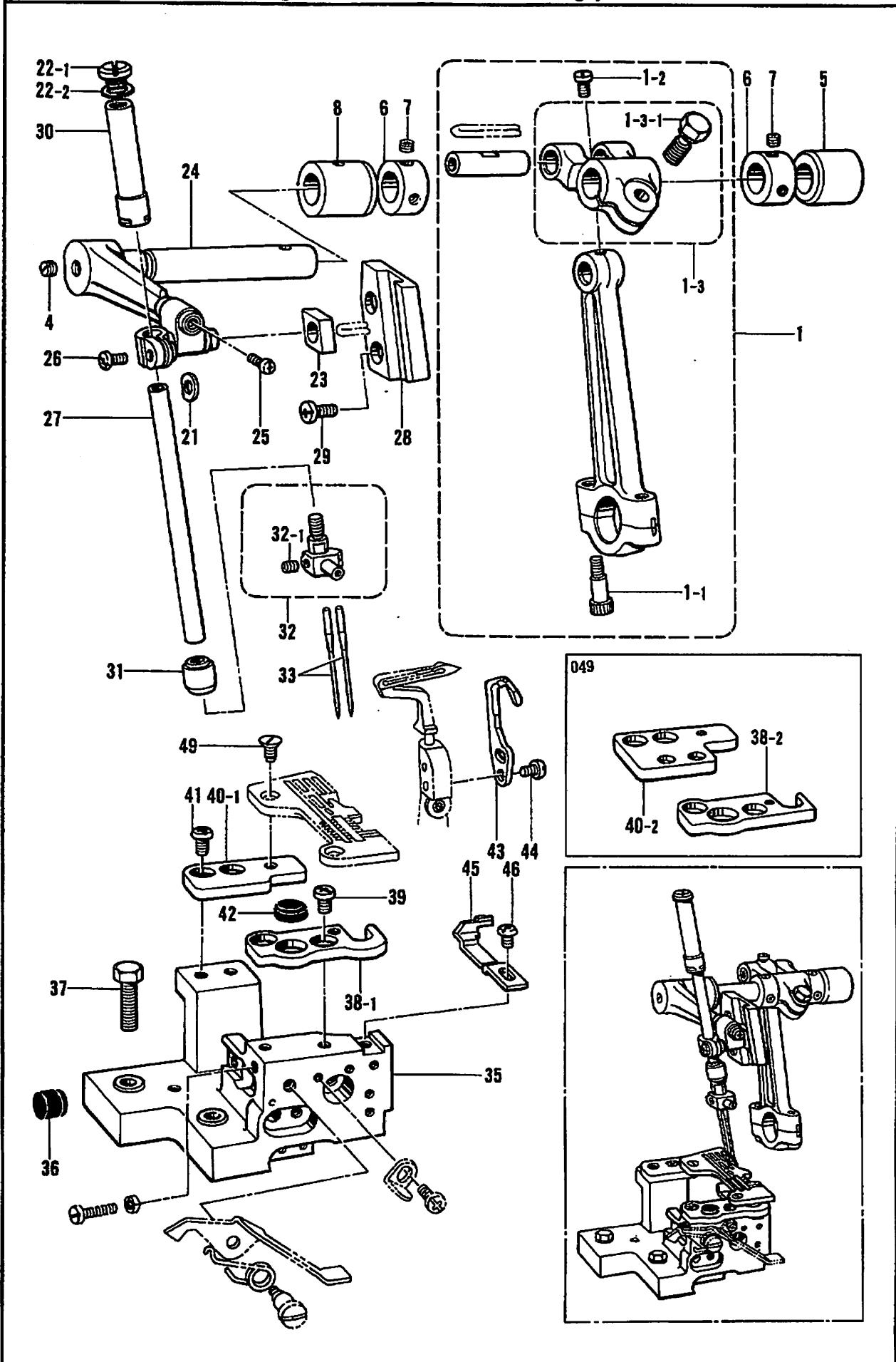
D. 針棒関係 / Needle bar mechanism / Nadelstangenvorrichtung /
