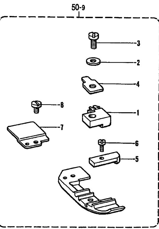
E. 押工関係/Presser foot mechanism/Stoffdrückerfuß/
