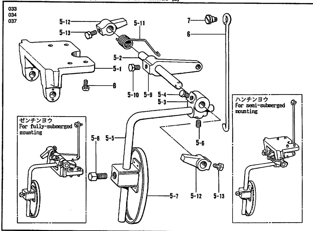
J. ラッパー関係/Lapper mechanism/Falz-Mechanismus/
