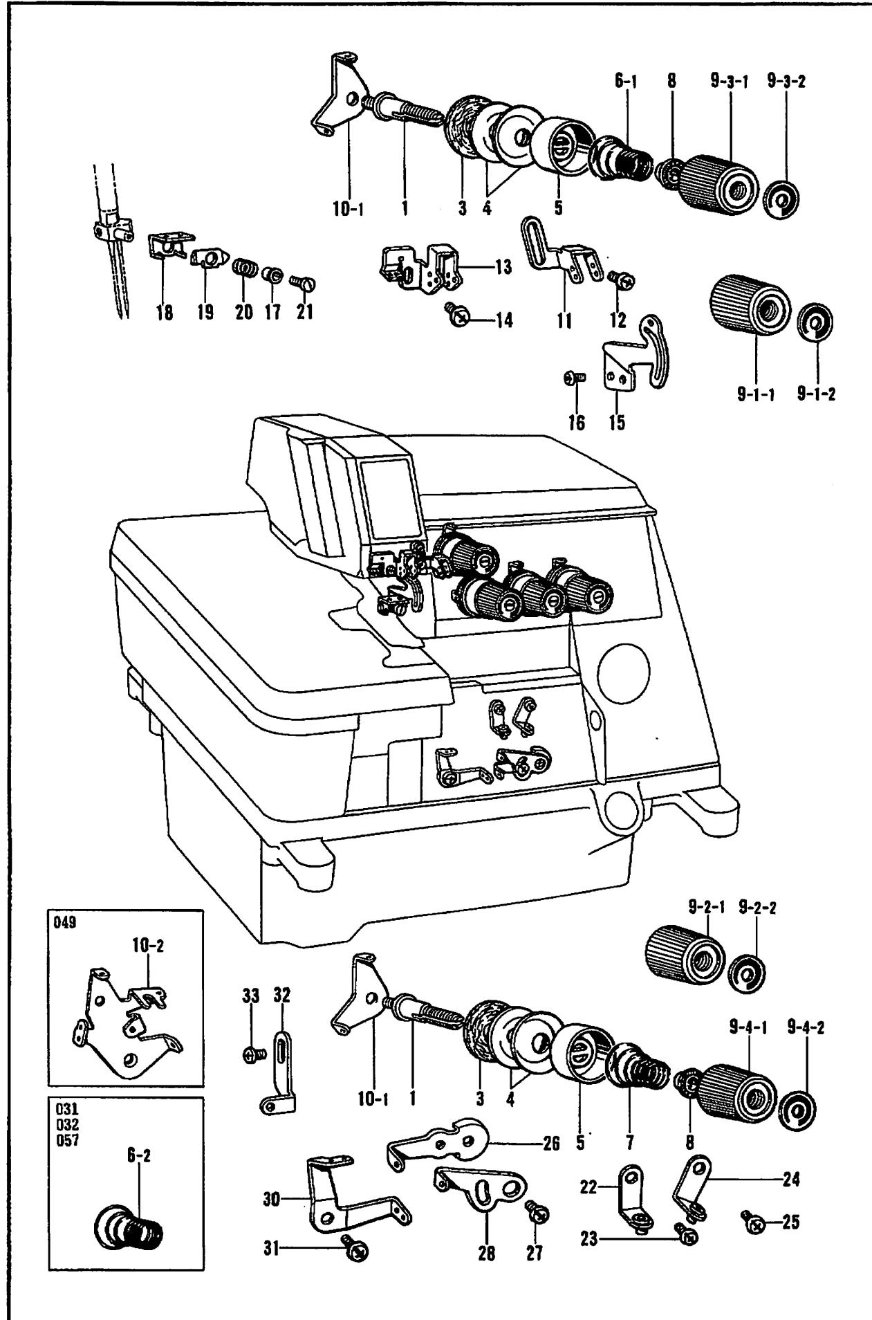
R. 糸調子関係/Thread tension/Faderspannung/Tension du fil/Tensión del hilo
