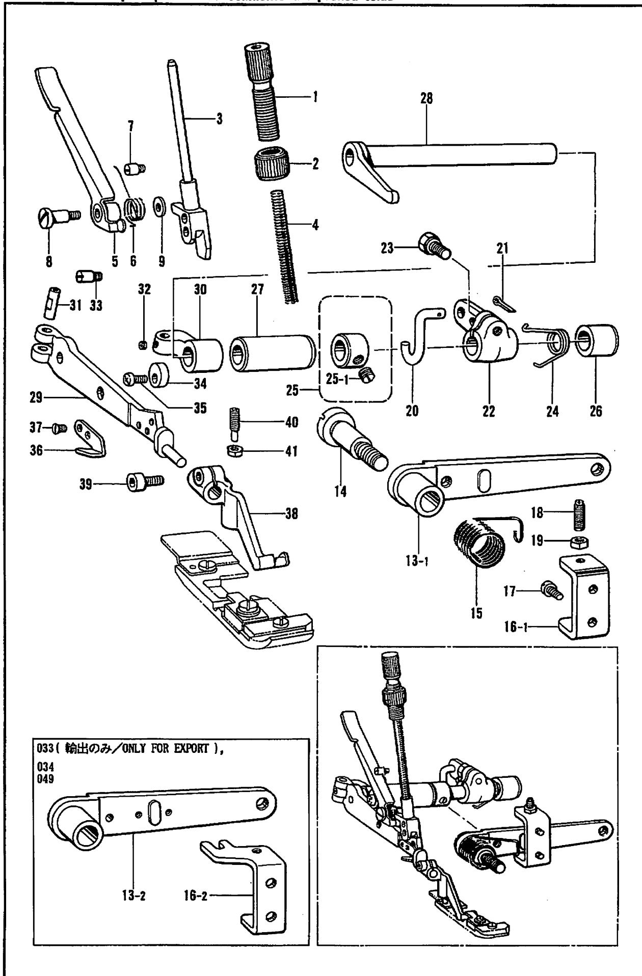
E. 押工関係/Presser foot mechanism/Stoffdrückerfuß/
