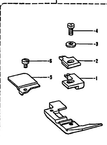
E. 押工関係 / Presser foot mechanism / Stoffdrückerfuß /
