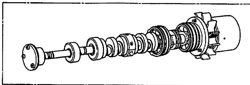
C. 針冷却装置/Needle cooler/Nadelkühlungsvorrichtung/
